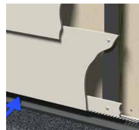
Commencez par une petite bande de panneau contre le pied du bâtiment.
